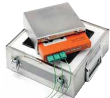
Falsch: Sondenkabel sind verdreht
