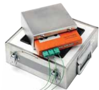
Incorrecto: Los cables de las sondas están retorcidos
