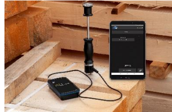
Abbildung 3 PCE-WMT 200 mit Messelektrode
