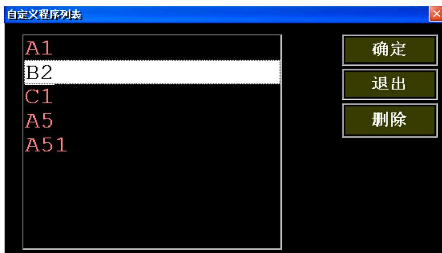
选择已有的程序如B2单击确定，LSG-6K10D 会自动按照事先设置好的“B2”程序中的参数，来完成测试。
