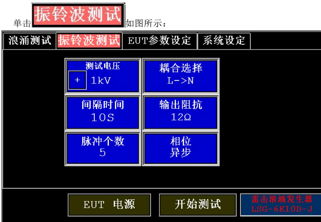
用户可以按照需求设置需要的测试电压、间隔时间、脉冲个数、耦合方式、输入阻抗、异步相位，设置方法可以参考浪涌设置。
