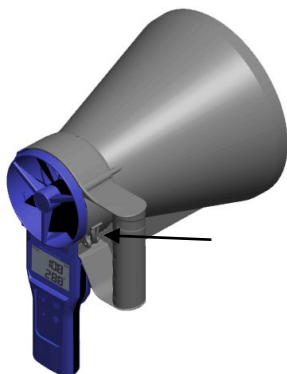
Abb. 7: Wöhler FA 410/430 in einen runden Messtrichter eingesetzt
