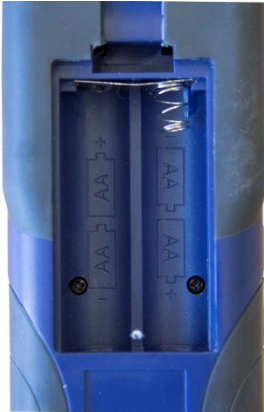
Fig. 19: Vano pile aperto
