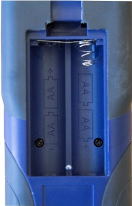
Abb. 4: Geöffnetes Batteriefach auf der Geräterückseite
