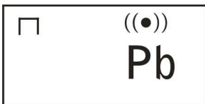
Afb. 16: Keuze „diëlektrische meetmodus“
