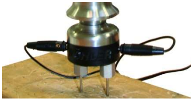
Abb. 9: Anschluss des Verbindungskabels an die Einschlagsonde
