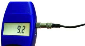
Afb. 21: Aansluiting van het verbindingsnoer op de Wöhler HBF 420
