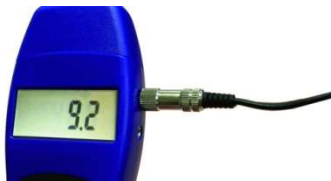
Abb. 10: Anschluss des Verbindungskabels an das Wöhler HBF 420
