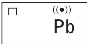
Abb. 5: Auswahl „dielektrischer Messmodus“
