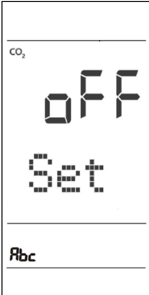
Abb. 13: ABC-Kalibrierfunktion (Auto Background Calibration)
