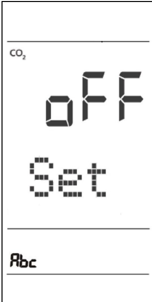
Afb. 43: ABC-kalibreerfunctie (Auto Background Calibration)
